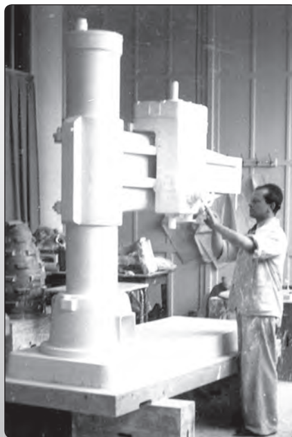
Obr. 1.9.2: Modelář při práci na sádrovém modelu vrtačky podle návrhu Vincence Makovského, počátek 40. let 20. stol.
