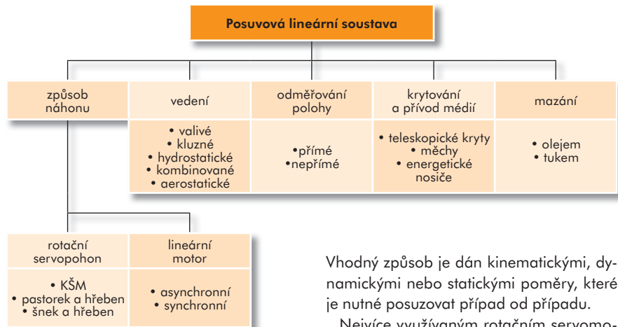
Obr. 3.3.1: Morfologie posuvové soustavy
