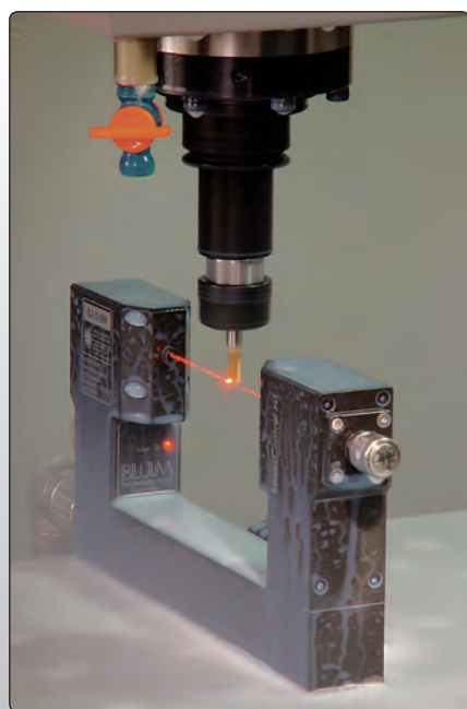
Obr. 3.8.6: Měřicí mechanismus nástrojové sondy s laserovým generováním signálu [Blum]
