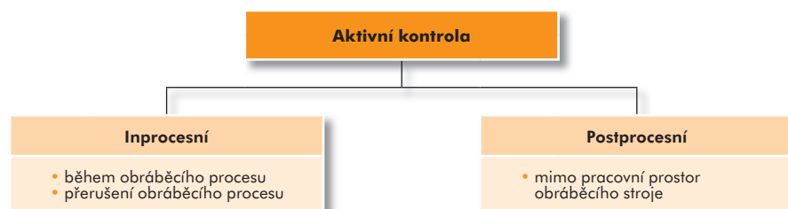
Obr. 3.8.2: Typy aktivní kontroly na CNC obráběcích strojích
