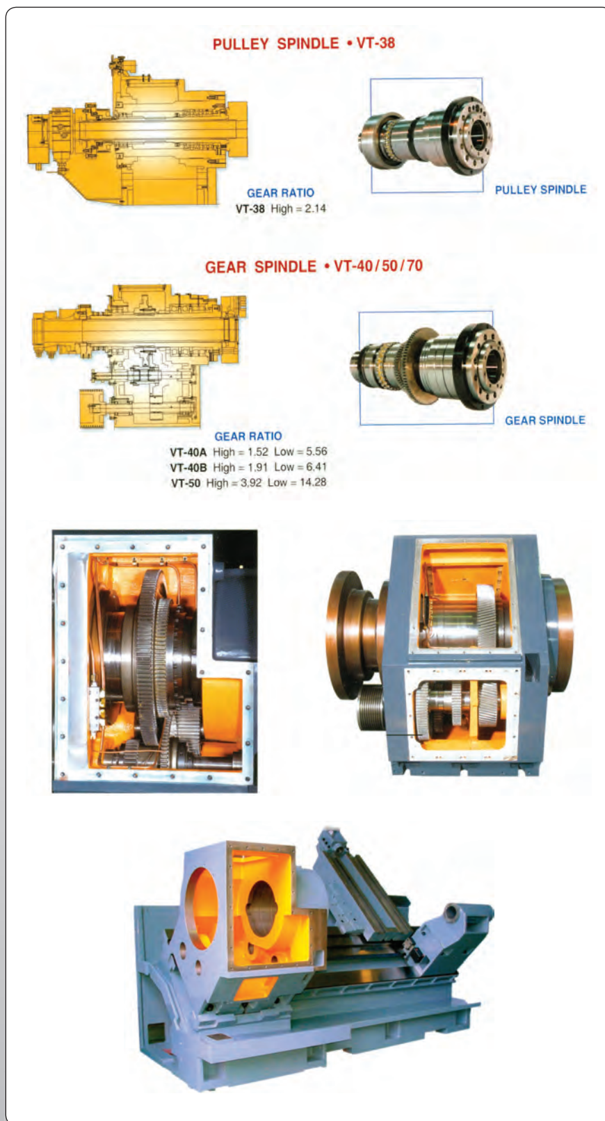
Obr. 4.1.9: Příklad provedení náhonů a uložení vřetena [Viper]
