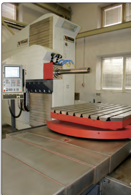
Obr. 9.2.9: CNC vyvrtávací stroj WFC 10 [Fermat]
