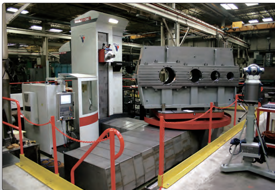
Obr. 9.2.1: CNC vyvrtávací stroj WFT 13 CNC [Femat]
